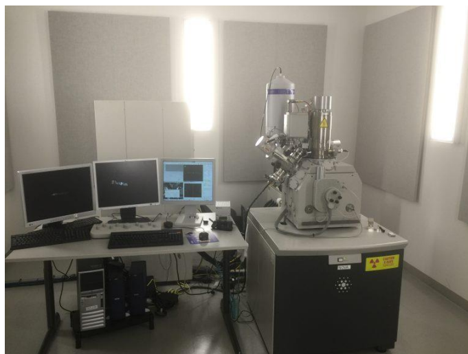
Рисунок 2.8 – Растровый электронный микроскоп FEI Nova Nanolab 200 FIB/SEM
