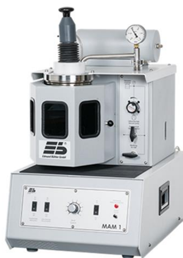
Рисунок 2.2 – Печь электродуговая Mini Arc Melter MAM-1 с высоковакуумной камерой
