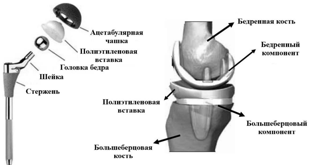
Рисунок 1.1 – Схема тотального эндопротезирования тазобедренного и коленного суставов [5]
