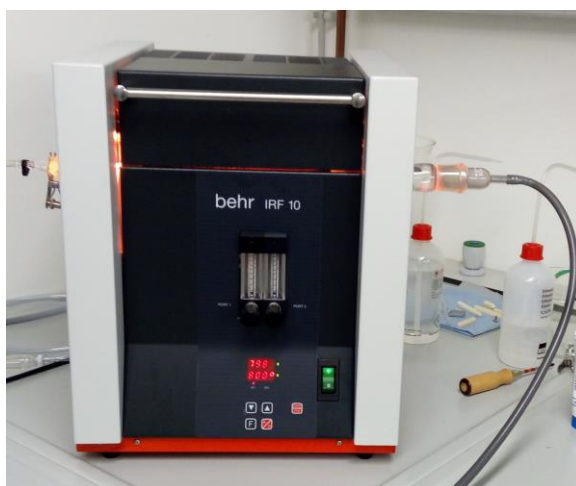
Рисунок 2.4 – Программируемая инфракрасная печь Behr IRF 10
