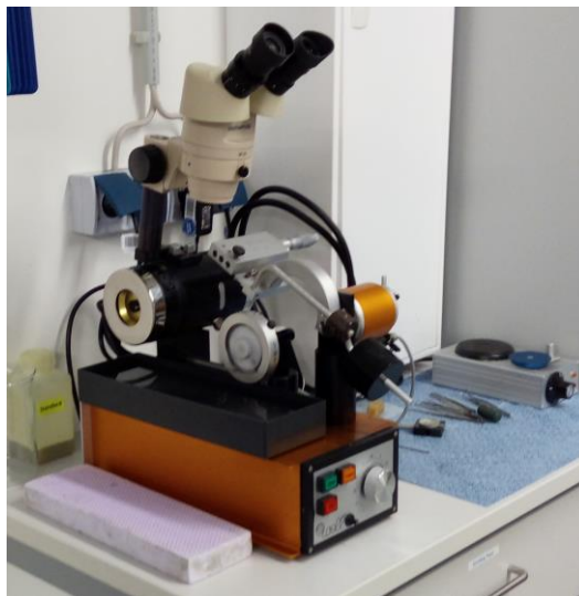
Рисунок 2.3 – Горизонтальная алмазная проволочная пила (модель 3032)
