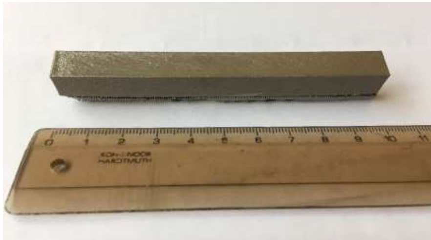
Рисунок 2.2 – Горизонтальный образец из сплава Ti-6Al-4V, изготовленный на 3D-принтере
