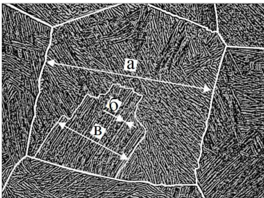
Рисунок 1.13 – Схема микроструктуры сплава Ti-6Al-4V: а) размер исходного \beta -зерна; б) толщина \alpha -пластин; в) размер скоплений с параллельными \alpha -пластинами [55]
