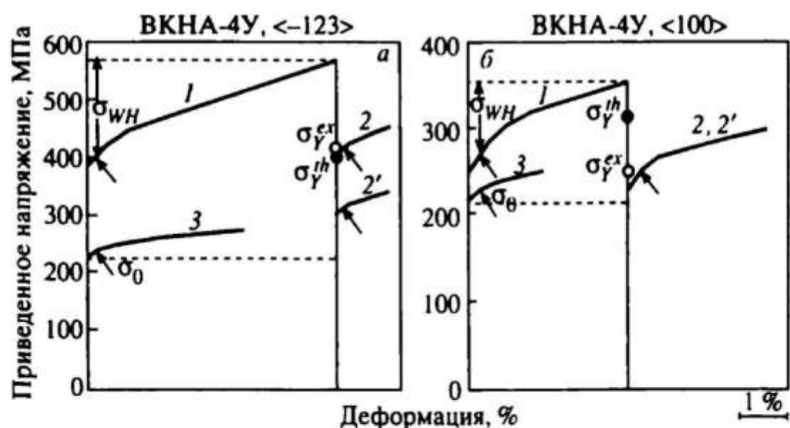
Рис. 13.10. Схематическое изображение деформационных кривых монокристаллов суперсплава ВКНА-4У (см. рис. 13.4) при ориентировках: \langle 123 \rangle (а), \langle 100 \rangle (б)
