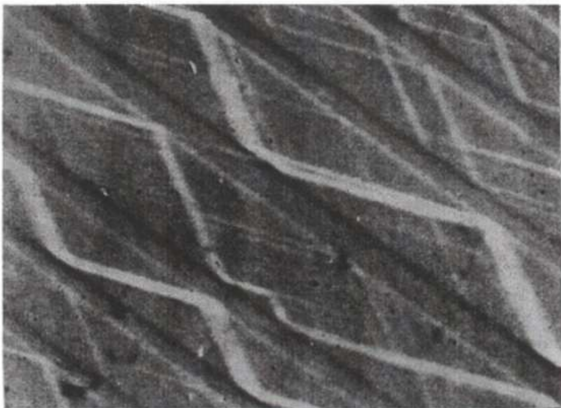
Рис. 6.7. Следы скольжения, локализованные внутри доменов одной ориентировки. \times 25\ 000
