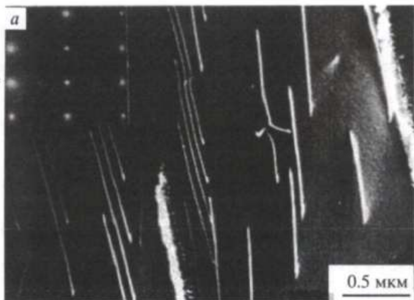
Рис. 16.10. Дислокационная структура синтезированных образцов:
