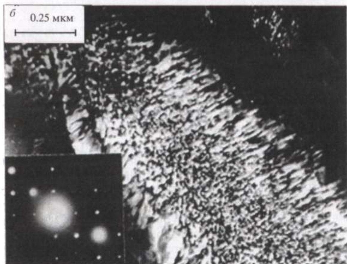
Рис. 16.5. Мартенситная структура образца Ti—25 ат. % Al: a — светлопольное изображение; б — темнопольное изображение в сверх- структурном рефлексе 010_{\alpha_2} , ось зоны [100]^*_{\alpha_2}
