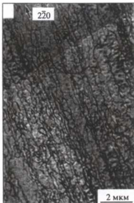
Рис. 12.1. Дислокационная структура [021] монокристалла Ti—56 ат. % Al, деформированного при 800 °С. Системы скольжения 1/2[1\bar{1}0](111) и 1/2[110](\bar{1}\bar{1}\bar{1}) одиночных дислокаций имеют наибольшие факторы Шмида, равные 0.490 (см. [14] глава 3)
