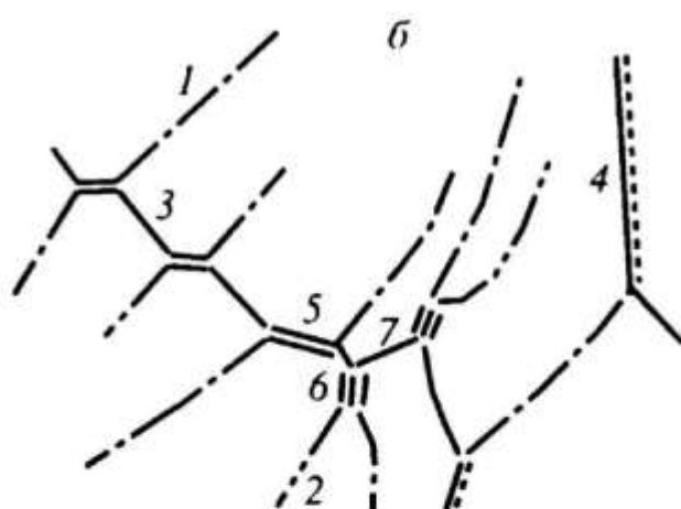
Рис. 5.15. Микроструктура сплава Ti—50 ат. % Al, деформированного при 800^{\circ}\text{C} :
