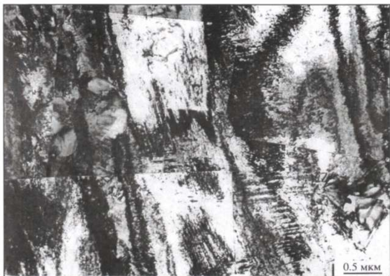
Рис. 15.11. Структура деформированного сплава FePd, отожженного при 575 °С, 2ч
