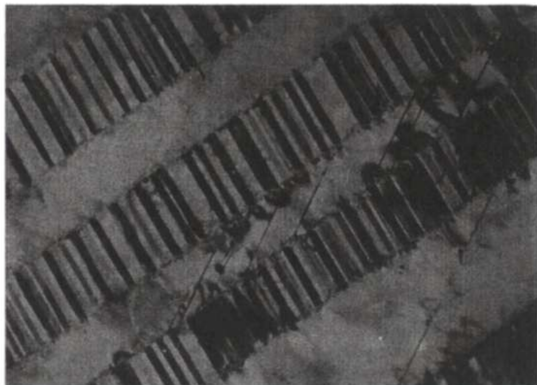
Рис. 6.13. Микродвойники, заторможенные границами доменов. \times 50\ 000
