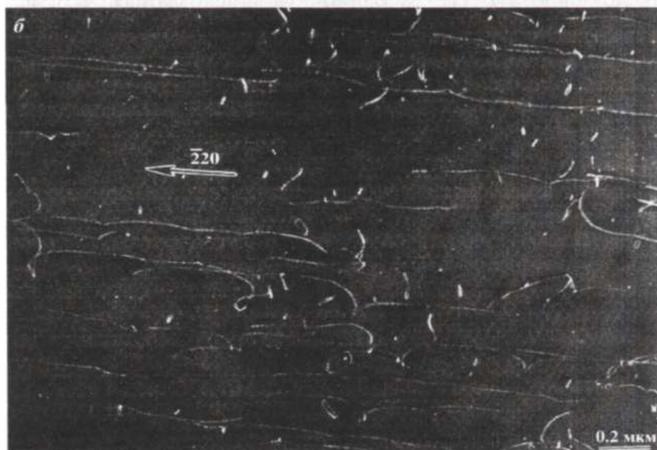
Рис. 5.9. Одиночные дислокации в сплаве TiAl, деформированном при 600 °C [10]:
