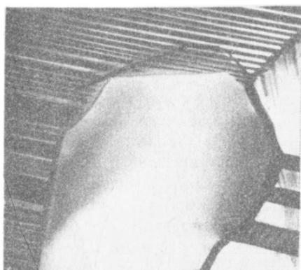
Рис. 54. Зародыш рекристаллизации, возникший на границе игл (ориентировка зерна [310], зародыша [100]); фольга на просвет. X30000
