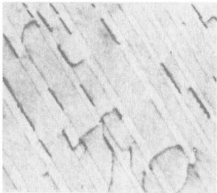
Рис. 65. Одиночные дислокации в упорядоченном сплаве CuAu с размером доменов 0,3 мкм; фольга на просвет,  $\epsilon = 2\%$ . X50000
