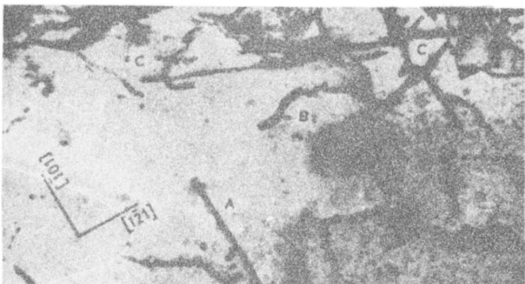
Рис.21. Дислокационная структура в плоскости (111) монокристалла упорядоченного сплава  $Cu_3Au$  с ориентировкой [001]
