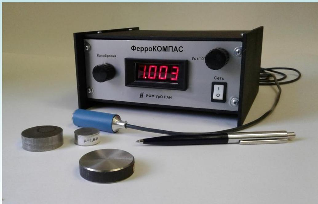
Прибор ФерроКОМПАС предназначен для измерения магнитной проницаемости маломагнитных материалов. Прибор позволяет проводить измерения проницаемости на поверхности контролируемых объектов локальным методом на различную глубину от 1 до 10 мм. Прибор проходит испытания на утверждение типа для внесения в Госреестр РФ.
