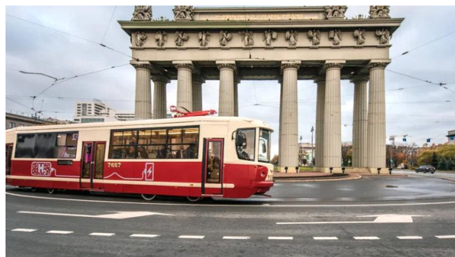
Фото 3. Разработка Крыловского государственного научного центра - действующий макетный образец трамвая с энергоустановкой на топливных элементах во время испытаний.
