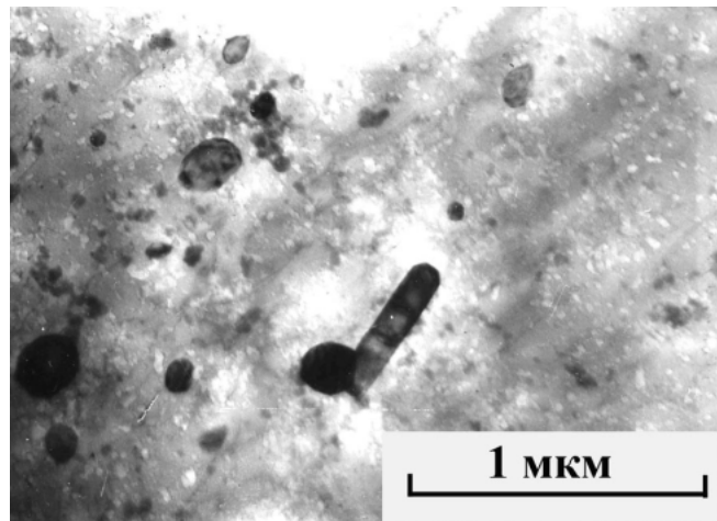
Рисунок 1.13. Зарождение пластинчатого кристалла аустенита на межфазной границе феррит/цементит при быстром нагреве до температур начала \alpha \rightarrow \gamma превращения в сплаве 10Н6 с исходной структурой феррит+цементит; V_n = 5000 \text{ }^\circ\text{C/s} .
