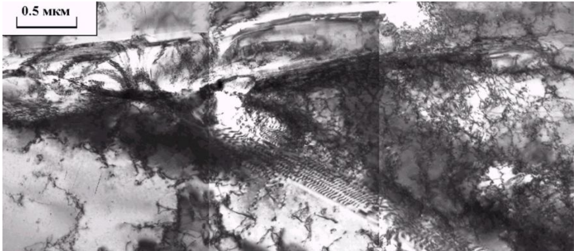
Рисунок 4.15. Область локализованного течения и канал проникания в образце меди, нагруженном высокоскоростным потоком частиц SiC.
