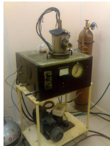
Рисунок 2.1 – Внешний вид установки для плавки в дуговой печи.
