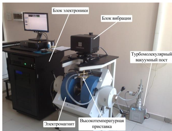
Рисунок 2.5 – Взаимное расположение измерительных катушек и образца: На схеме: Ш - шток; О - образец; ИК - измерительные катушки; Э - электромагнит. Справа представлен внешний вид вибромагнетометра Lake Shore 7407 VSM.
