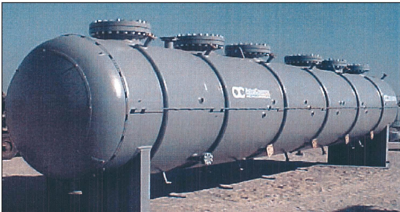
Рисунок 3.23 – Корпус химического реактора. Композит сталь-медь-тантал [84]
