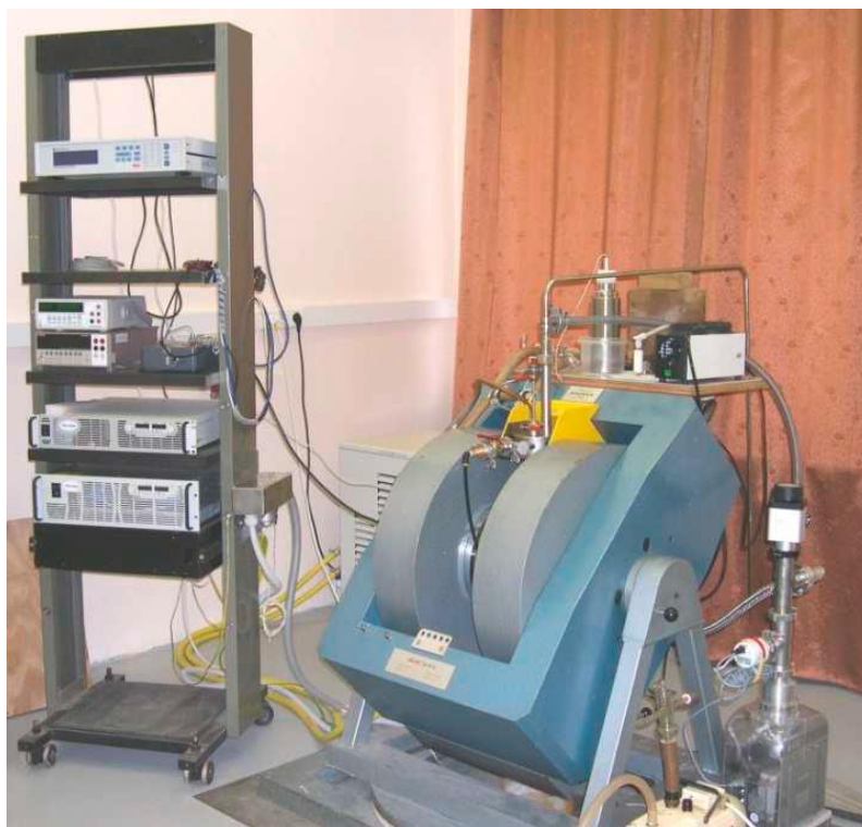
Рисунок 41 - Установка RTF-1 для измерения магнитосопротивления спиновых клапанов при различных температурах.
