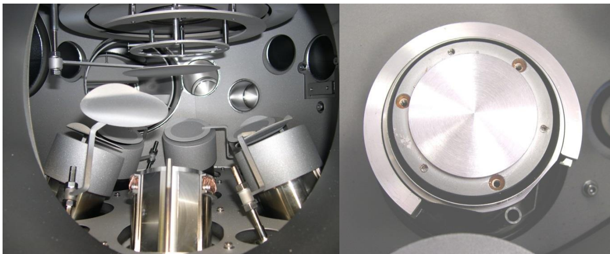
Рисунок 36 - Внутренняя часть камеры напыления металлов (а); мишень, прикрепленная к держателю и не покрытая колпаком (б).
