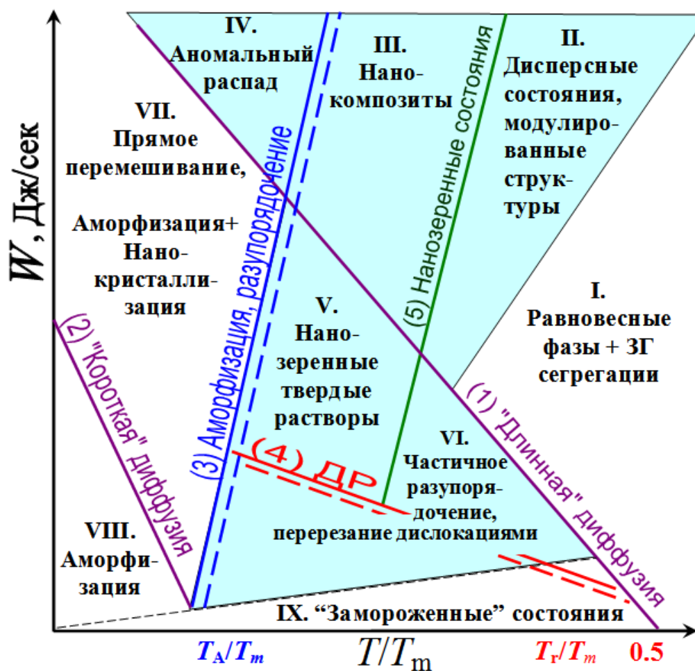
Рисунок 7.3 – Диаграмма неравновесных стационарных состояний сплава в условиях интенсивной пластической деформации. Область неравновесных диффузионных фазовых превращений закрашена. [A21]
