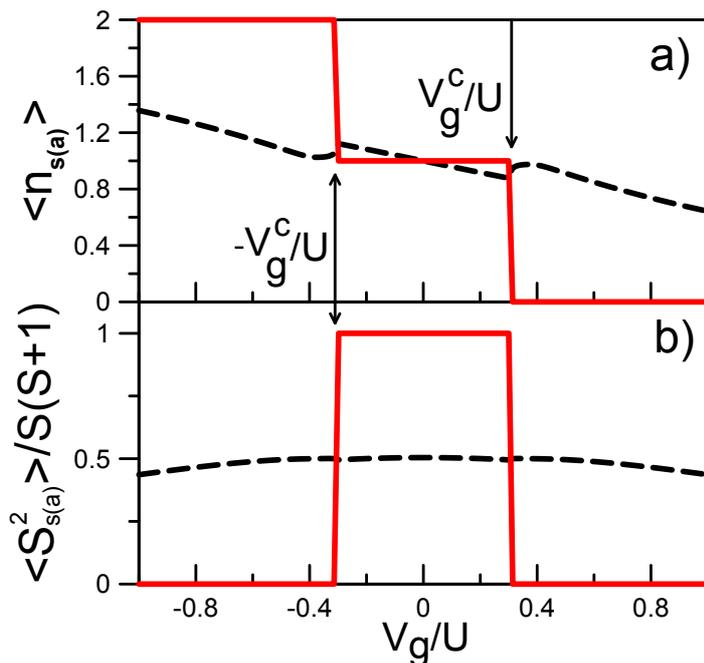
Рисунок 3 — Результат метода функциональной ренормгруппы с контрчленом для  $\langle n_{s(a)} \rangle$  (a) и  $\langle \mathbf{S}_{s(a)}^2 \rangle$  (b). Штриховые линии – результаты для связывающего состояния, сплошные линии – для антисвязывающего состояния. Напряжение  $\pm V_g^c$  (стрелки) соответствует квантовому фазовому переходу. Параметры системы и метода расчета соответствуют Рисунку 2.
