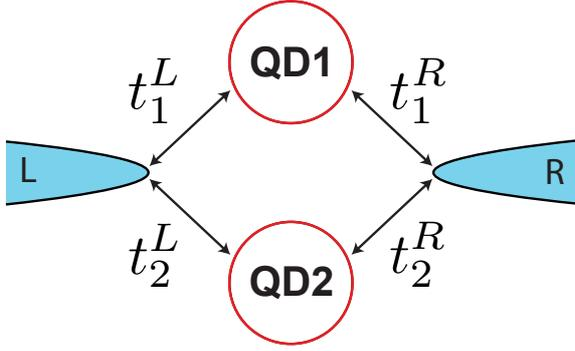
Рисунок 1 — Схематическое представление системы двух квантовых точек QD1 и QD2, соединенных с левым (L) и правым (R) контактами.
