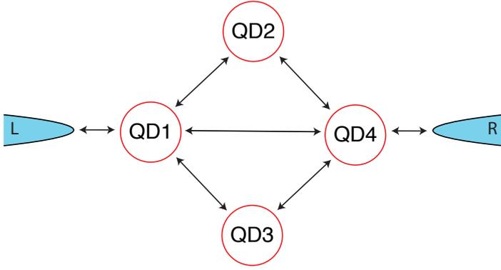
Рисунок 6 — Схематическое представление системы четырех квантовых точек (QD1-QD4), соединенных с левым (L) и правым (R) контактами.
