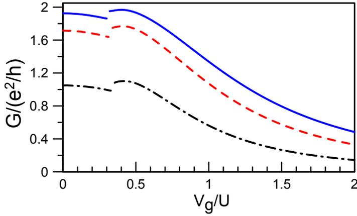
Рисунок 4 — Проводимость  $G$  как функция напряжения  $V_g$  в методе функциональной ренормгруппы с контрчленом при  $\Gamma_1^L = \Gamma_2^L = U/4$ ,  $\Gamma_1^R = \Gamma_2^R = \chi\Gamma_1^L$  и  $H \rightarrow 0$  для  $\chi = 0.8$  (сплошная линия), 0.5 (штриховая линия) и 0.2 (штрихпунктирная линия).
