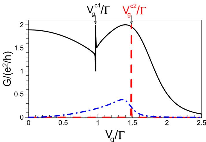
Рисунок 7 — Линейная проводимость  $G(V_g)$  в методе функциональной ренормгруппы при  $(t/\Gamma, \gamma) = (0.05, 0.9)$  (штриховая линия),  $(t/\Gamma, \gamma) = (0.5, 0.9)$  (сплошная линия) и  $(t/\Gamma, \gamma) = (0.5, 0.1)$  (штрихпунктирная линия). Для всех случаев  $U/\Gamma = 2$ ,  $H/\Gamma = 10^{-3}$ ,  $t_{14} = 0$ .
