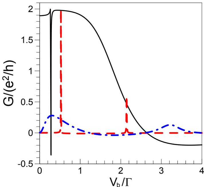
Рисунок 10 — Дифференциальная проводимость  $G$  как функция напряжения  $V_b$  в методе функциональной ренормгруппы при  $V_g = 0$  для  $(t/\Gamma, \gamma) = (0.05, 0.9)$  (пунктирная линия),  $(t/\Gamma, \gamma) = (0.5, 0.9)$  (сплошная линия) и  $(t/\Gamma, \gamma) = (0.5, 0.1)$  (штрихпунктирная линия: проводимость  $G$  умножена на 10). Остальные параметры соответствуют Рисунку 9.
