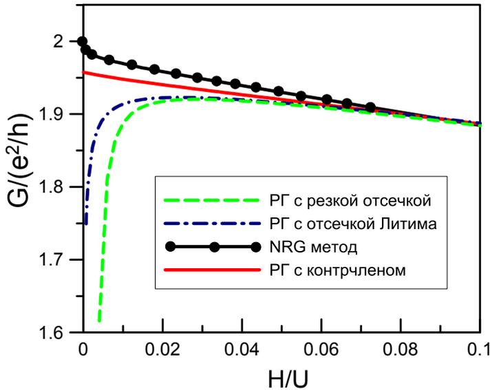
Рисунок 2 — Проводимость  $G$  как функция магнитного поля  $H$  при  $\Gamma_{ij}^{\alpha} = U/4$  и  $V_g = 0$  в методе функциональной ренормгруппы (РГ) с резкой и Литима схемами отсечки, методе NRG и методе функциональной ренормгруппы с контрчленом  $\sigma I \chi_1^{\Lambda}$  ( $\tilde{H}/U = 0.1$ ,  $\Lambda_c/U = 0.05$ ) при отсечке Литима.
