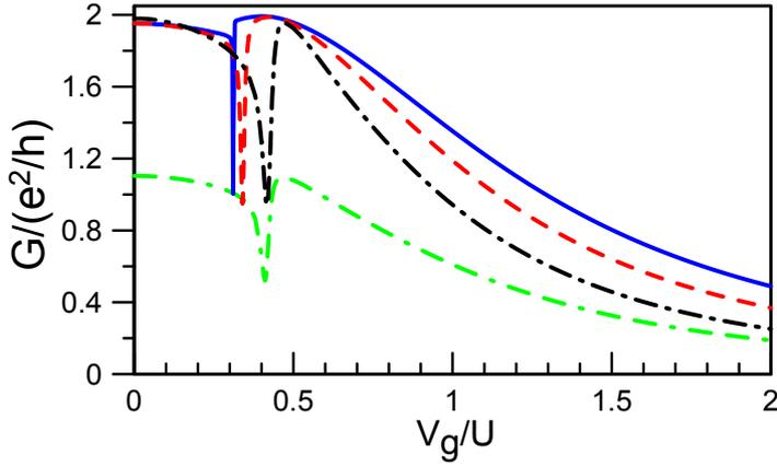
Рисунок 5 — Проводимость  $G(V_g)$  в методе функциональной ренормгруппы с контрольным при  $\Gamma_1^{L(R)} = U/4$ ,  $\Gamma_2^{L(R)} = \gamma\Gamma_1^L$  и  $H \rightarrow 0$  для  $\gamma = 0.8$  (сплошная линия), 0.5 (штриховая линия) и 0.2 (штрихпунктирная линия). Нижняя линия —  $G(V_g)$  при  $\Gamma_2^{L(R)} = \gamma\Gamma_1^{L(R)}$ ,  $\Gamma_{1(2)}^R = \chi\Gamma_{1(2)}^L$  с  $\gamma = \chi = 0.2$  и  $\Gamma_1^L = U/2$ .
