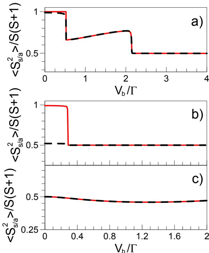
Рисунок 9 — Среднее значение квадрата оператора спина  $\langle \mathbf{S}_{s(a)}^2 \rangle$  на связывающем (штриховая линия) и антисвязывающем (сплошная линия) состояниях как функция напряжения смещения  $V_b$  в методе функциональной ренормгруппы при  $V_g = 0$  для  $(t/\Gamma, \gamma) = (0.05, 0.9)$  (a),  $(t/\Gamma, \gamma) = (0.5, 0.9)$  (b) и  $(t/\Gamma, \gamma) = (0.5, 0.1)$  (c). Остальные параметры системы соответствуют Рисунку 7.
