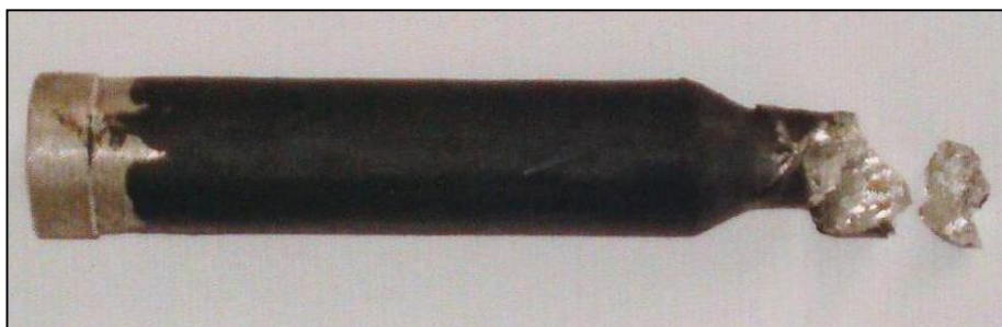
Рисунок 2.2 – Разрушение магниевой заготовки в процессе гидроэкструзии при комнатной температуре
