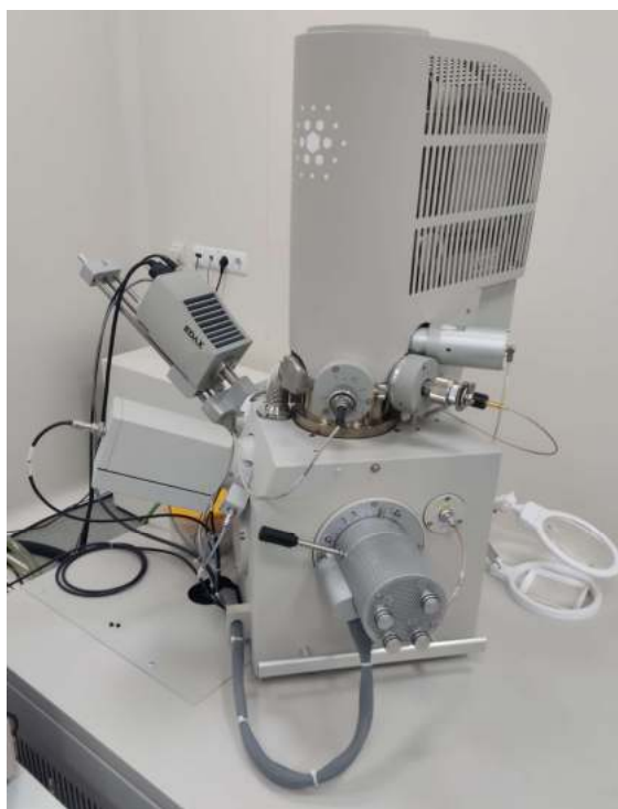
Рисунок 2.10 – Общий вид колонны растрового электронного микроскопа FEI Inspect F
