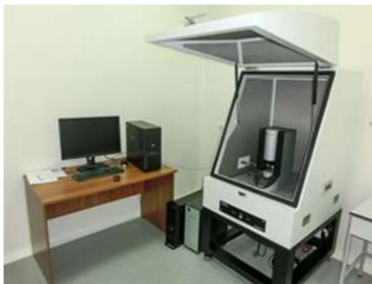
Рисунок 2.8 – Атомно-силовой микроскоп «Solver NEXT»
