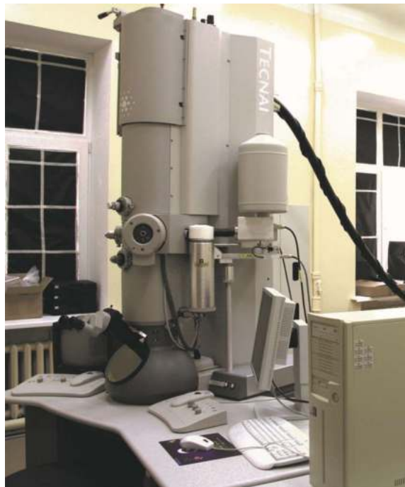
Рисунок 2.6 – Просвечивающий электронный микроскоп Теснаі G-30
