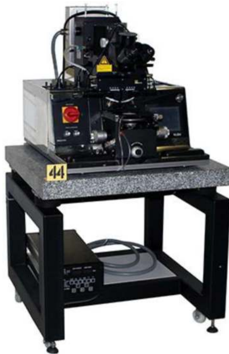
Рисунок 2.9 – Установка контактной фотолитографии MJB4 SUSS MicroTec
