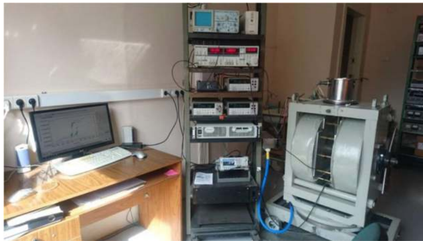
Рисунок 2.11 – Автоматизированный вибрационный магнитометр АВМ-1
