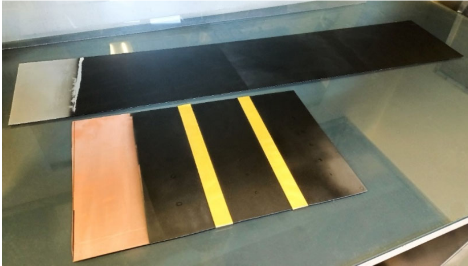
Рисунок 4.3.1 – Объекты контроля: 1 – лист алюминия, 2 – лист фольгированного текстолита
