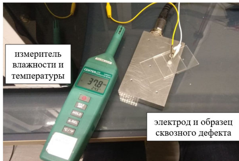
Рисунок 2.3.3 – Экспериментальная установка. Вид электрода, образца сквозного дефекта, измерителя влажности и температуры.
