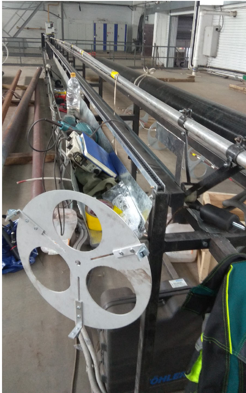
Рисунок 5.2.4. Внешний вид электроискрового дефектоскопа «Корона С» в составе с толкателем
