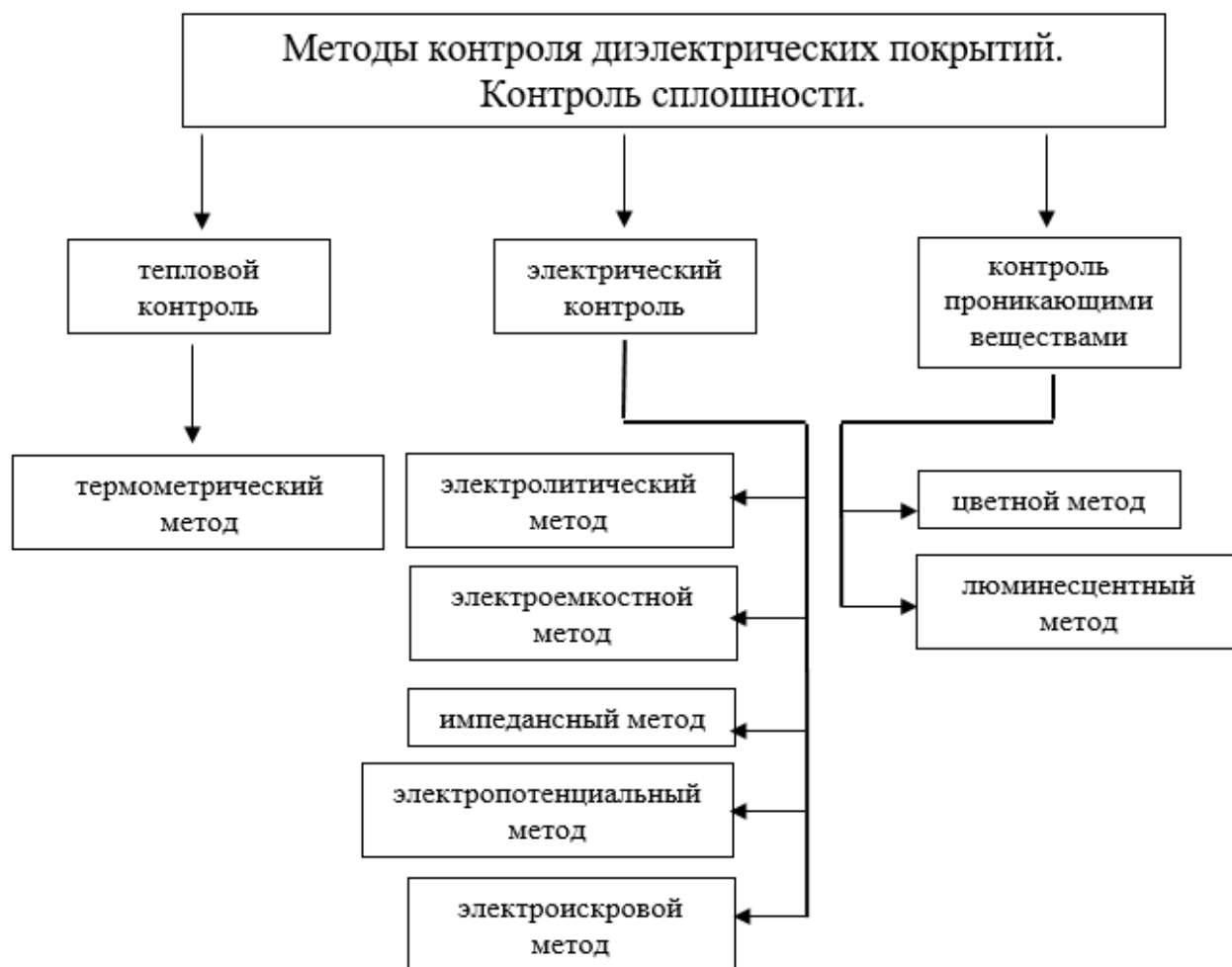
Рисунок 1.3.1 – Методы НК сплошности диэлектрических покрытий
