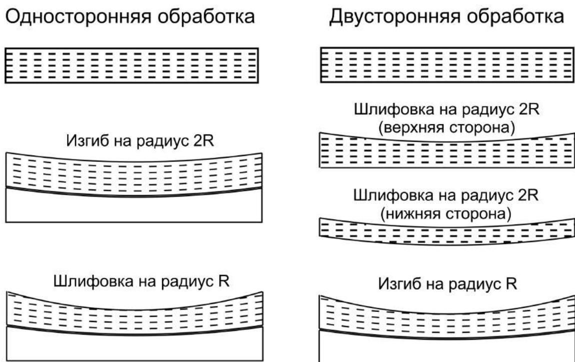
Рисунок А.15 — Цилиндрические кристаллы-анализаторы, изогнутые по Йогансону, с размером отражающей поверхности  $25 \times 80$  мм и радиусом изгиба 1 м, произведенные на ESRF: с односторонней (а) и двусторонней (б) обработкой поверхностей.
