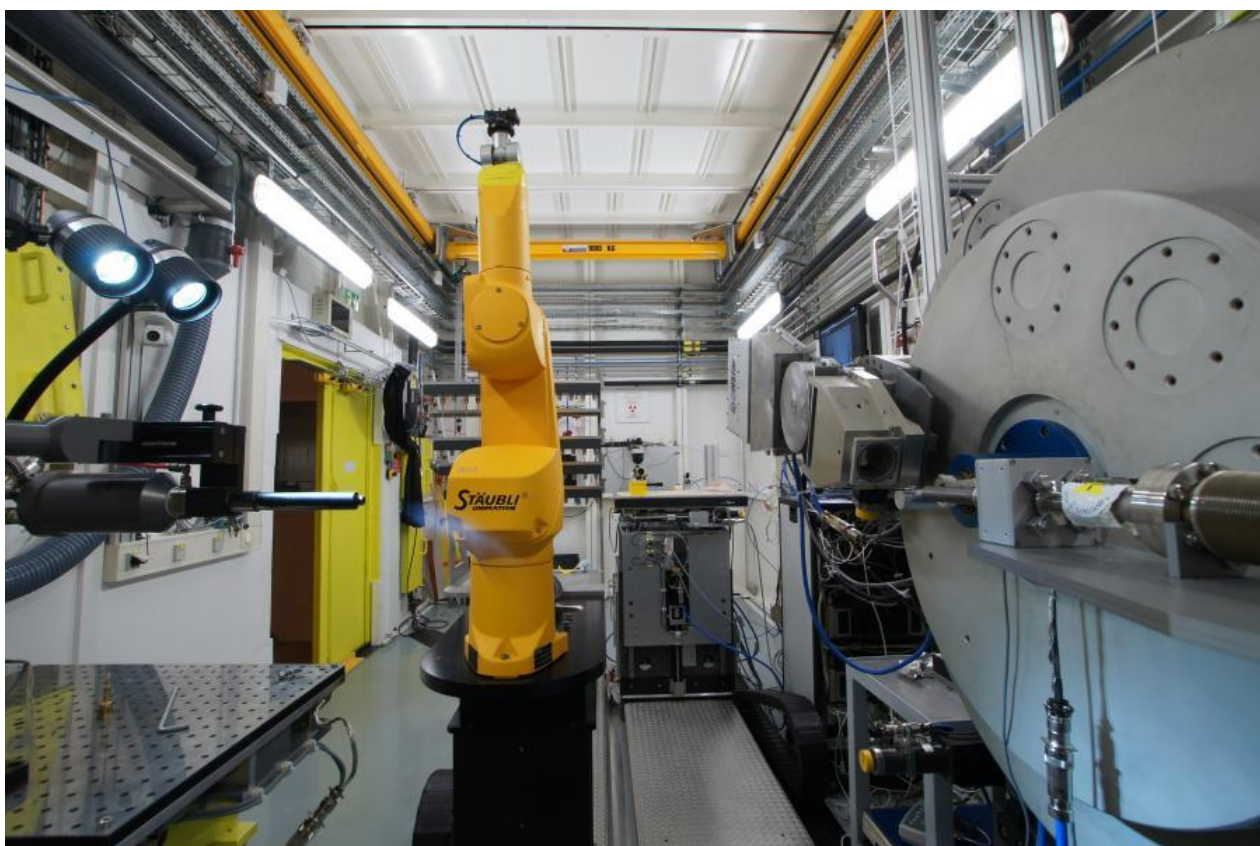
Рисунок 2.4 – Порошковый дифрактометр ID22 (справа), с роботом для смены образца (в центре) и криопотоком (слева)
