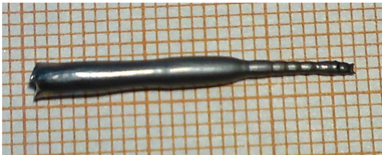
Рисунок 5.1 – Снимок монокристаллического образца \text{Ho}_5\text{Pd}_2 , полученного по методу Чохральского в Институте физики Силезского университета в Катовице, Польша
