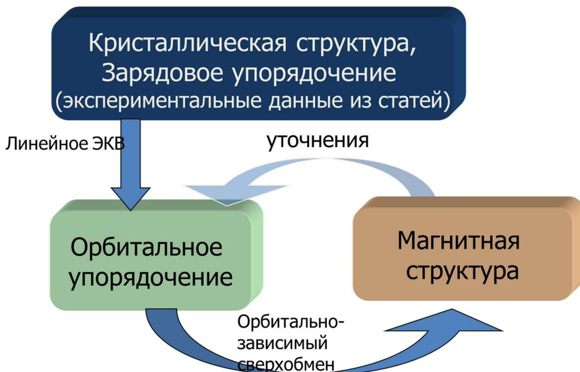
Схема 1 – Применение модели расчета магнитных свойств диэлектрических манганитов на основе орбитально-зависимого сверхобменного взаимодействия
