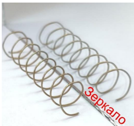
Рисунок 1.2 – Демонстрация наличия хиральности у объекта, выполненного в форме спирали. Зеркальное отражение правозакрученной спирали соответствует левозакрученной спирали. Левозакрученная спираль не может быть совмещена с правозакрученной спиралью ни при каких сдвигах и поворотах
