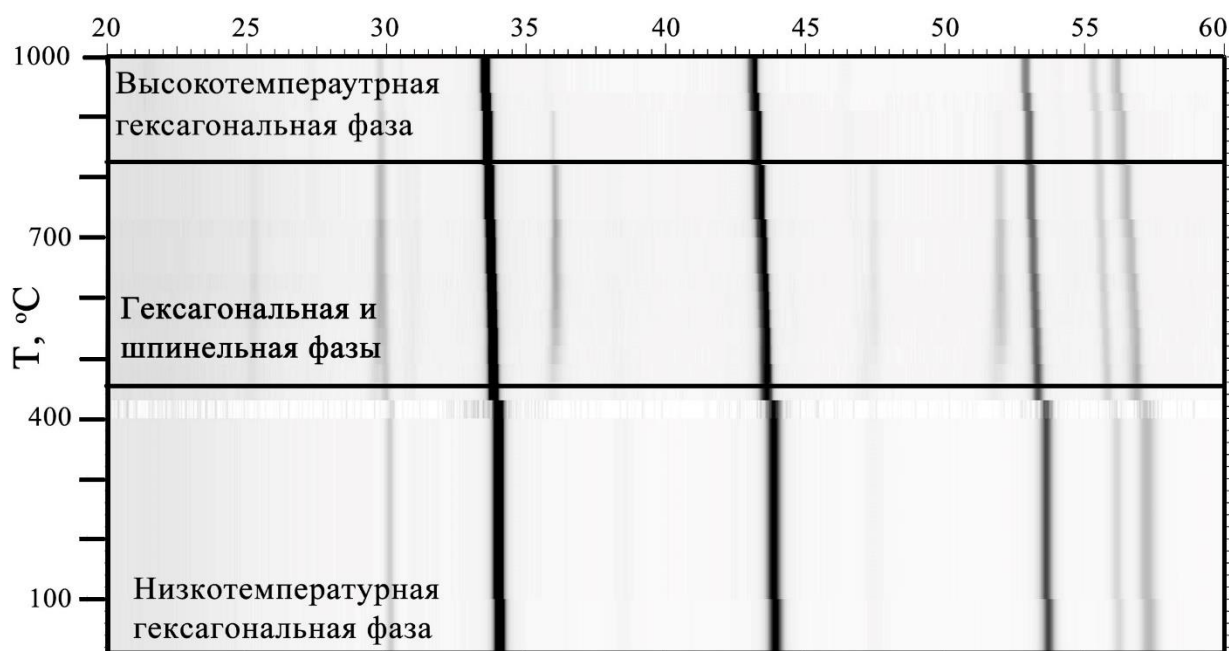
Рисунок 5 – Рентгенограммы \text{Cu}_{0.1}\text{TiS}_2 «вид сверху», полученные при нагреве in situ . Значения 2\theta пересчитаны для излучения \text{CuK}\alpha . По оси OX – угол 2\theta , по оси OY – температура съемки, цвет от белого к черному – интенсивность [30]
