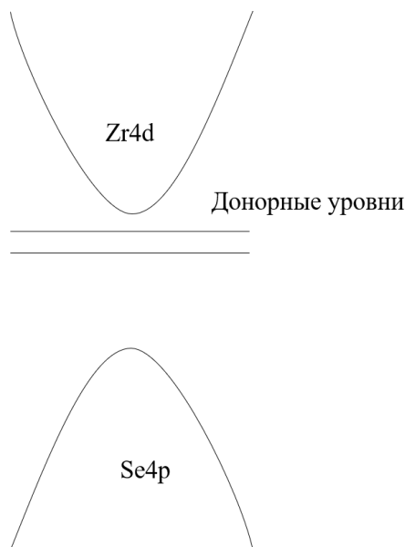
Рисунок 64 – Схема зонной структуры \text{Cu}_x\text{ZrSe}_2 с примесными уровнями, созданными межслоевым Zr и интеркалированной медью
