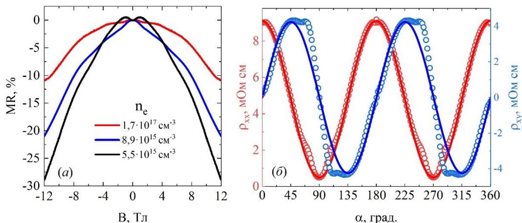
Панель а – Магнитополевая зависимость относительного продольного магнитосопротивления  $MR$  в HgSe при температуре 150 К для образцов с разной концентрацией электронов  $n_e$ .
