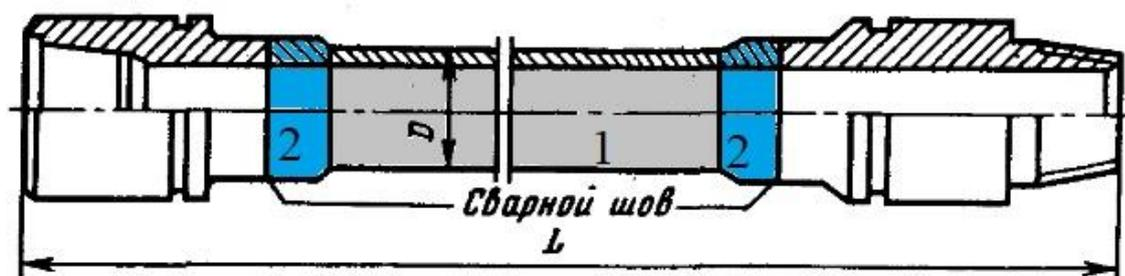
Рис. 8 Бурильная труба. Область 1 — тело трубы; область 2 — область высадки тела бурильной трубы. L – общая длина бурильной трубы; D – наружный диаметр тела бурильной трубы.
