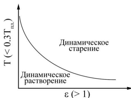
Рис. 1. Граница инверсии направления атомного массопереноса в индуцированных большой пластической деформацией структурно-фазовых переходах в стареющих сплавах.
