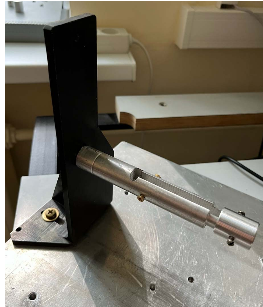
Рисунок 4 – фиксаторы для образцов в форме параллелепипеда – слева, установка для закрепления образцов в форме параллелепипеда – справа
