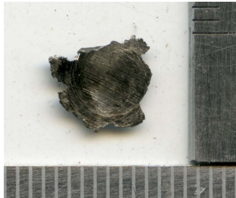
Образец вольфрама, подверженный интенсивной деформации при высоком давлении при температуре 570 К (297 °С)
