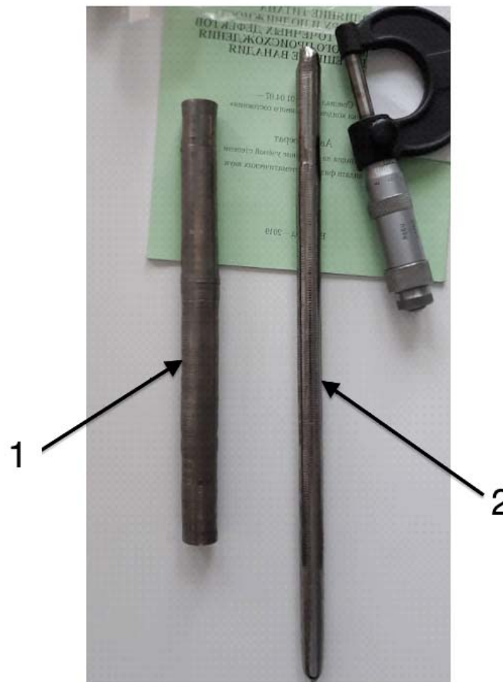
Исходные крупнокристаллический образцы вольфрама. 1 - из Усть-Каменогорска, ТУ 48-0531-220-80, 2 – ИФМ УрО РАН
