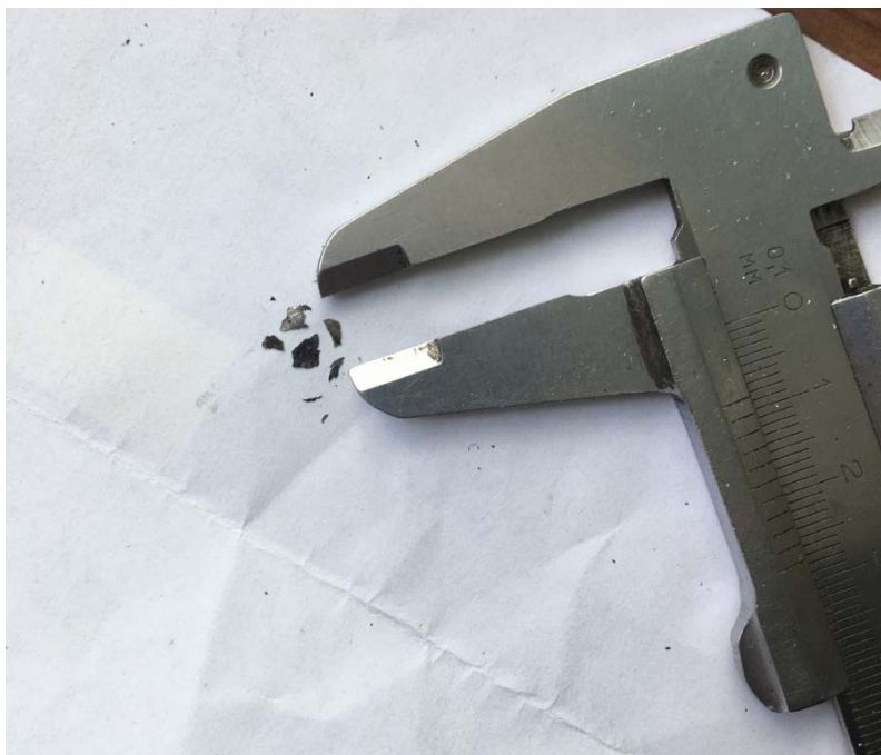
Образец вольфрама, подверженный интенсивной деформации при высоком давлении при температуре 80 К (-193 °С)
