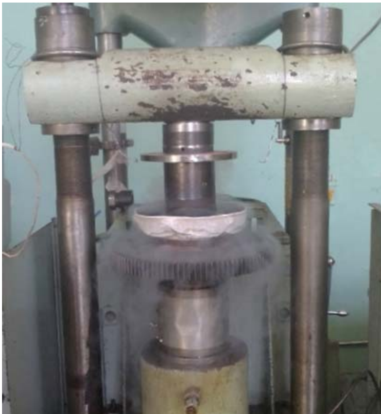
Гидравлический пресс с камерой Бриджмена в кювете с жидким азотом
