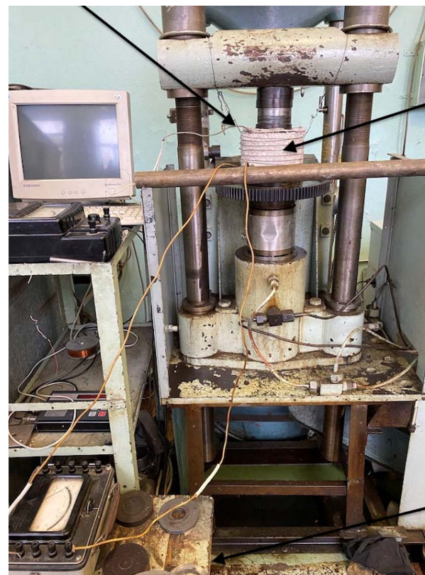
Гидравлический пресс с камерой Бриджмена в цилиндрической электропечи с нихромовой спиралью
