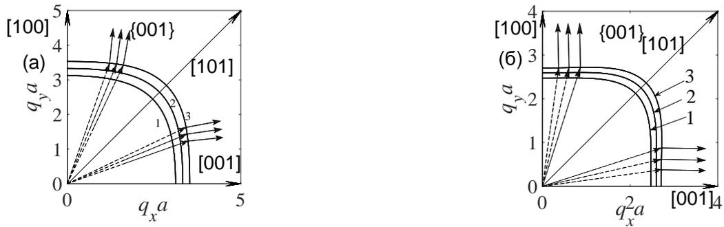
Рисунок 3.4 — Линии постоянной частоты в плоскости  $\{001\}$  при  $\xi = -0.3$  (а) и  $\xi = -0.7$  (б). Линии 1 соответствуют частоте  $0.8\omega_{max}$ , линии 2 –  $0.9\omega_{max}$ , и линии 3 –  $0.999\omega_{max}$ . Штриховыми стрелками обозначены волновые векторы, сплошными – направления групповых скоростей.
