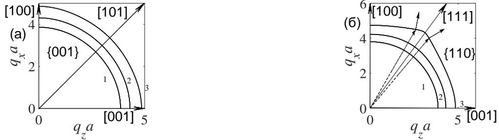
Рисунок 3.2 — Линии постоянной частоты в EuO ( $\xi = 0.2$ ) (а) в плоскости  $\{001\}$  и (б) в плоскости  $\{110\}$ . Линии 1 соответствуют частоте  $0.8\omega_{max}$ , линии 2 –  $0.9\omega_{max}$ , и линии 3 –  $0.999\omega_{max}$ . Штриховыми стрелками обозначены волновые векторы, сплошными – направления групповых скоростей.
