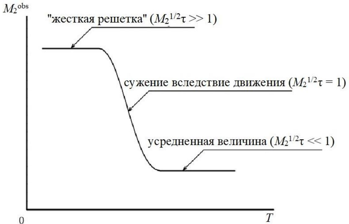
Рисунок 1.3 – Второй момент как функция температуры в твердом теле с термически активированным атомным движением.
