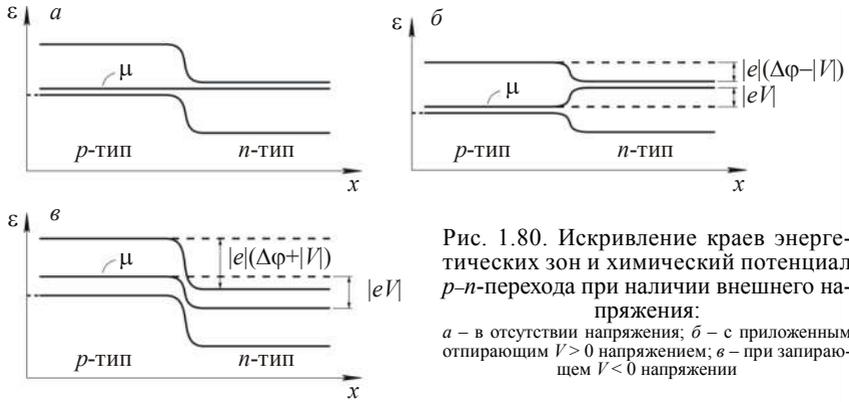
Рис. 1.80. Искривление краев энергетических зон и химический потенциал  $p$ - $n$ -перехода при наличии внешнего напряжения:
