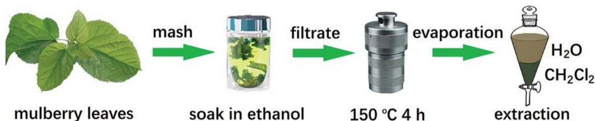
Рис. 1. Схема синтеза УТ из листьев шелковицы
