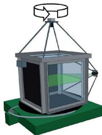
Рис. 1. Экспериментальная установка. Кубометр воды вращается с угловой скоростью до 1 оборота в секунду.
